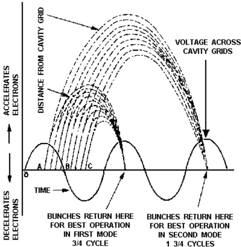
Figure 2-11.—Bunching action of a reflex klystron.
