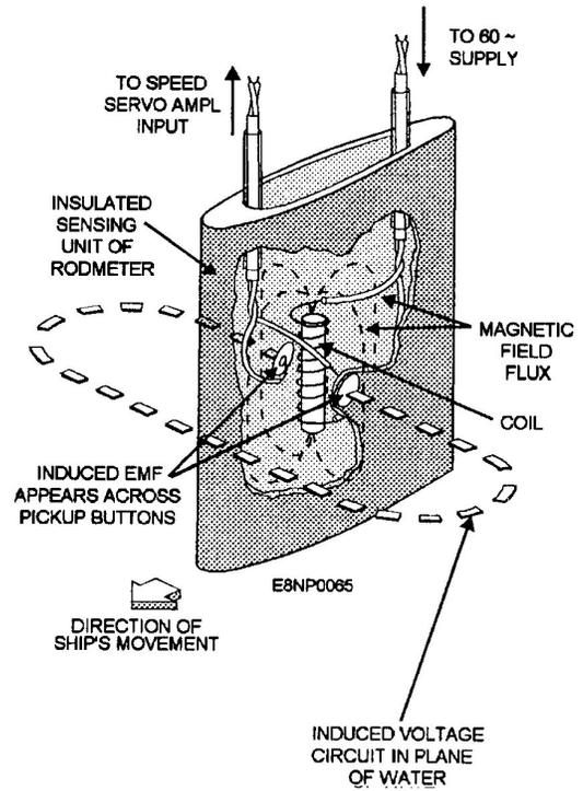
**Figure 4-9.-Rodmeter sensing unit.**
