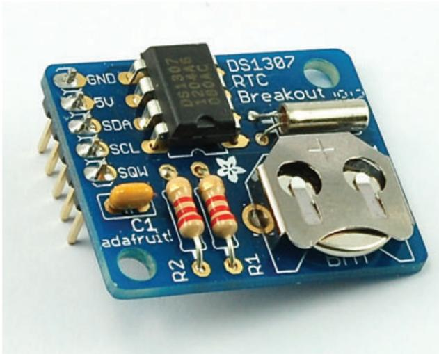
**FIGURE 7-39** An RTC module
