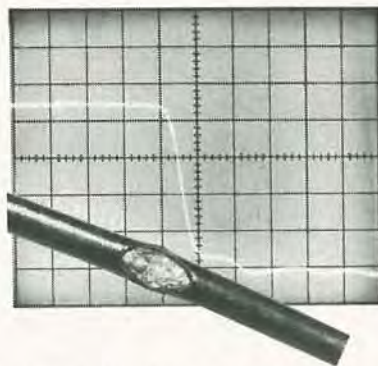
FIG. 2—A TEKTRONIX 1502 displays a short circuit.
