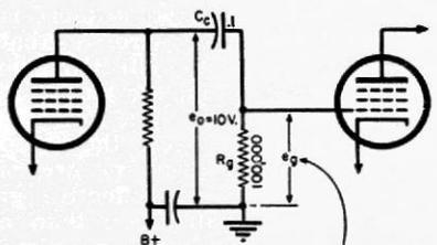
VOLTAGE ON GRID APPROXIMATELY EQUAL TO 10 VOLTS AT 1000 CYCLES BUT DECREASES AS REACTANCE OF COUPLING CAPACITOR INCREASES
