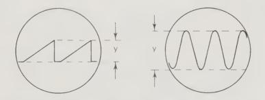
Fig. 1.7 Measuring AMPLITUDE PEAK-TO-PEAK.
