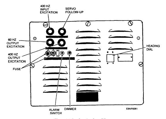
Figure 4-5.-Synchro signal amplifier,
