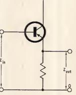
Fig. 1.11. Emitter fallower impedance converter
