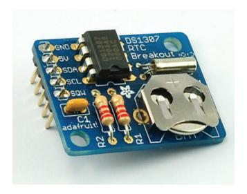
FIGURE 7-39 An RTC module
