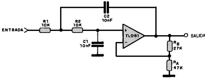
**FILTRO CON SEGUIDOR DE TENSION**
