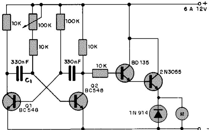
Este circuito se usa para controlar pequeños motores eléctricos de corriente continua. El control es por pulsos y la banda está determinada por el valor del potenciómetro. Para corrientes por arriba de 500mA, hasta 2A, hay que montar el transistor con disipador de calor.
