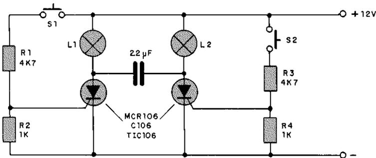
Presionando S1, se enciende L1. Presionando S2 se enciende L2 y se apaga L1. Las lámparas son de 12V para corrientes hasta de 500mA. El capacitor de 2,2µF debe ser despolarizado.
