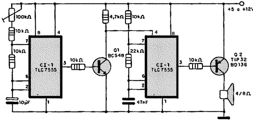
La frecuencia de los bips está dada por el resistor de 10kΩ, P1 y por el capacitor electrolítico de 10μF, pudiendo ser alterados según el efecto que el lector desee. En este circuito, la carga -un pequeño parlantes excitada por un transistor, pero podemos tener la excitación directa de un transductor cerámico, según fue sugerido en los proyectos anteriores.
