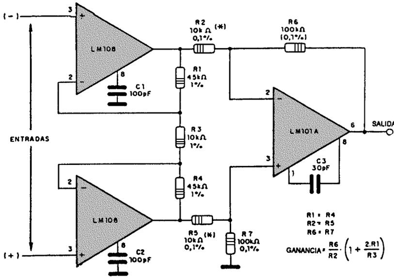
Este circuito también opera con una tensión de 100-0-100V de entrada, pero tiene por base 3 amplificadores operacionales. Los resistores marcados con asteriscos deben acoplarse de modo de garantizar un buen rechazo en modo común. Los demás resistores deben mantener las relaciones indicadas en el diagrama.
