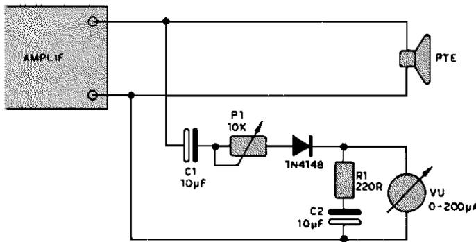
Este circuito emplea un Vúmetro común de bobina móvil y puede conectarse en la salida de cualquier amplificador de audio. El punto de funcionamiento en función de la potencia se regula con P1. C2 determina la inercia en la actuación del VU.
