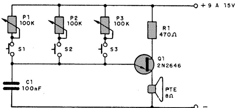
Los tonos obtenidos al presionar los interruptores dependen de los ajustes de P1, P2 y P3. La banda de ajustes depende también de C1 que puede tener valores entre 47nF y 220nF. La potencia es relativamente baja y podrá sustituirse el altoparlante por un resistor de 100 ohm y llevar la señal a la entrada de un amplificador.
