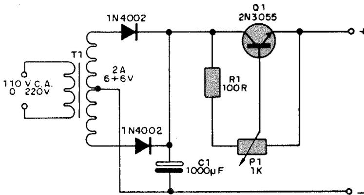
Esta fuente proporciona corrientes hasta 2A para cargas cuya resistencia depende de factores externos, como en el caso de las cubas electrolíticas. El transistor Q1 debe montarse con disipador de calor y en P1 se hace el ajuste de la intensidad de la corriente.
