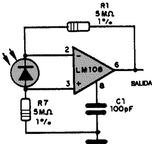
**AMPLIFICADOR PARA FOTODIODO (II)**
