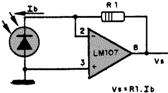
**AMPLIFICADOR PARA FOTODIODO**
