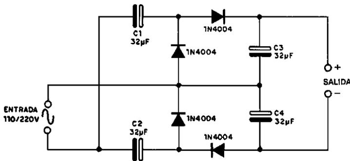
Con esta configuración, se puede obtener una tensión cuatro veces mayor de la que sería posible por la rectificación de la onda completa, a partir de los 220V de la red. Los capacitores deben tener una tensión de trabajo por lo menos 50% mayor que el valor pico de la red local.
