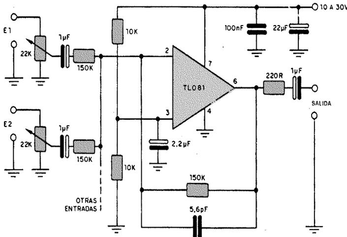
Este mixer emplea un amplificador operacional con FET en la entrada (Texas Ins.) y presenta una excelente ganancia determinada por el resistor de 150k en el circuito de realimentación. Se diseñaron sólo dos entradas, pero puede aumentarse su número hasta 10 sin problemas. Los resistores son de 1/8W y las conexiones de entrada y de salida deben ser blindadas.
