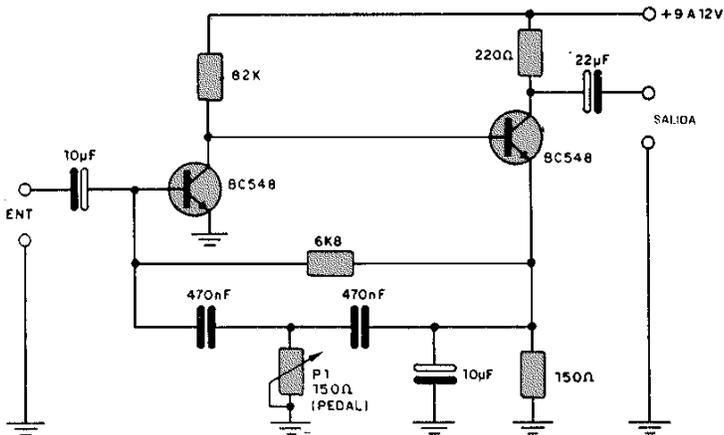
Este circuito produce efectos moduladores del sonido de una guitarra, si se intercala entre el captador de alta impedancia, o preamplificador, y el amplificador. Los cables de entrada y salida deben ser blindados. El potenciómetro P1 se acopla al pedal de efectos.
