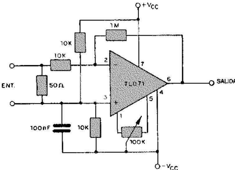
**AMPLIFICADOR PARA CORRIENTE ALTERNA**
