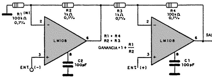
Este amplificador para instrumentación presenta una elevadísima impedancia de entrada y su ganancia está determinada por la expresión en el mismo diagrama. Observe la necesidad de utilizar resistores de precisión para el correcto acoplamiento de características entre las dos ramas del circuito.
