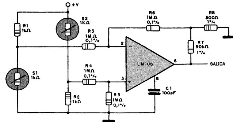
El amplificador que muestra la figura puede utilizarse con cualquier sensor resistivo con resistencia de 1kΩ y se caracteriza por la existencia de una compensación de ruido. R5 debe ser variable, pudiendo ser ayudado para un mejor rechazo en modo común. R8 determina la ganancia del circuito.
