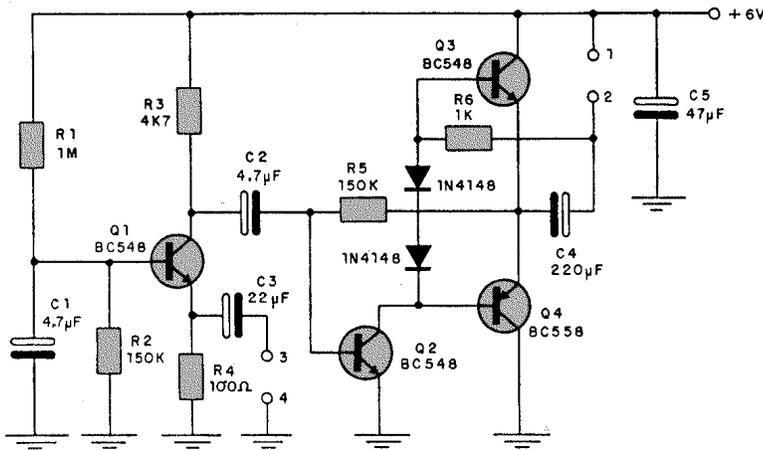
Este pequeño amplificador posee una etapa de entrada de baja impedancia para usarse como entrada para parlantes usados como micrófonos. Se puede emplear como intercomunicador. Los terminales 3 y 4 son de entrada y los 1 y 2 de salida, de modo que mediante una llave se pueden conmutar las funciones de las estaciones. Debido a la baja impedancia de la línea, las estaciones no deben estar separadas por más de 20 m de alambre.
