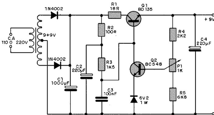
Esta fuente tiene protección contra las sobrecargas en el circuito de salida. El punto de disparo del sistema de protección, formado por Q2, está determinado por el ajuste de P1. La fuente emplea un transformador de 9 + 9V y proporciona corrientes hasta de 200 mA.
