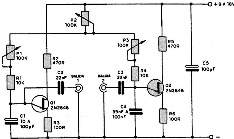
La frecuencia de modulación está dada por C1 y controla con P1. La profundidad de modulación está dada por P2. P3 controla la tonalidad del sonido, que también depende de C4. Las dos salidas posibles de este circuito se muestran con formas de onda en diente de sierra.
