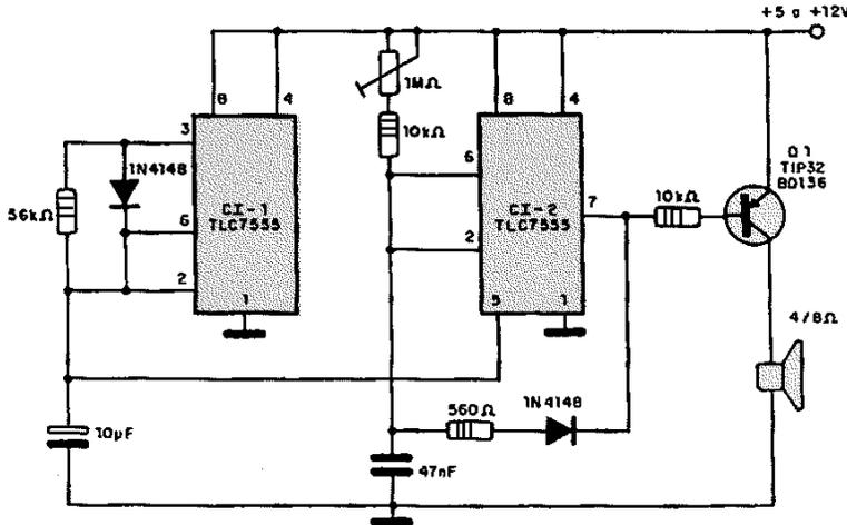
Aquí tenemos una modulación en frecuencia, la cual es producida por una señal diente de sierra generada por CI1. La frecuencia de este oscilador es de aproximadamente 1Hz, con un tiempo de bajada muy rápido dado por el diodo entre los pins 3 y 6. Esta señal modula el segundo oscilador, formado por CI2, cuya frecuencia está en la banda de audio y podrá ser ajustada en el trim-pot.
