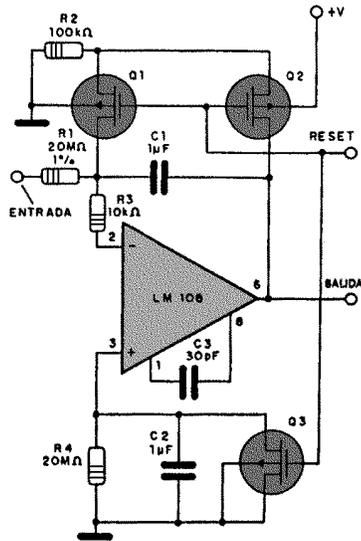
Este circuito presenta un bajo desvío de características con el tiempo de funcionamiento (menor que  $500\mu\text{V/s}$  en la banda de  $-55^{\circ}\text{C}$  a  $+125^{\circ}\text{C}$ ) y tiene por base un amplificador operacional del tipo LM108. Los transistores de efecto de campo utilizados en este circuito no deben tener diodos internos de protección.
