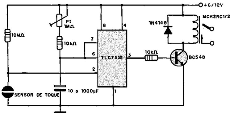
Resistores de valores tan altos como 50MΩ pueden usarse en la temporización de entrada de disparo de este integrado, lo que garantiza una gran sensibilidad al circuito. La temporización en esta aplicación es ajustada en el potenciómetro P1. Esta alta resistencia de entrada permite la utilización de sensores resistivos diversos en el disparo del TLC7555.
