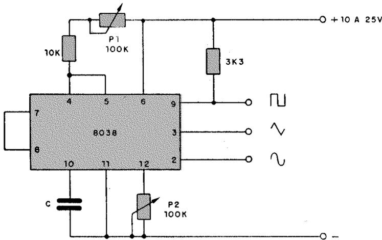
Este circuito produce señales rectangulares, triangulares y sinusoidales en la banda de frecuencia comprendida entre 0,1Hz y 100kHz. El capacitor C determina la banda de frecuencias que se regulará con P1. C puede tener valores de 150pF a 15mF según las frecuencias deseadas.
