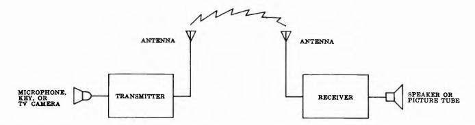
Figure 1 ELEMENTS OF A COMMUNICATION SYSTEM USING RADIO WAVES
