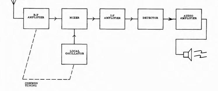
Figure 7 BLOCK DIAGRAM FOR THE SUPERHETERODYNE RECEIVER
