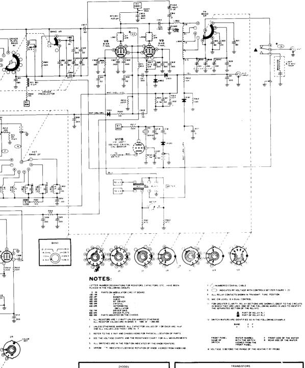
SCHEMATIC OF THE HEATHKIT® SSB TRANSCEIVER MODEL HW-101
