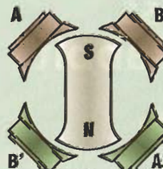
Step 5: Phase A: (-)ON Phase B: (-)ON
