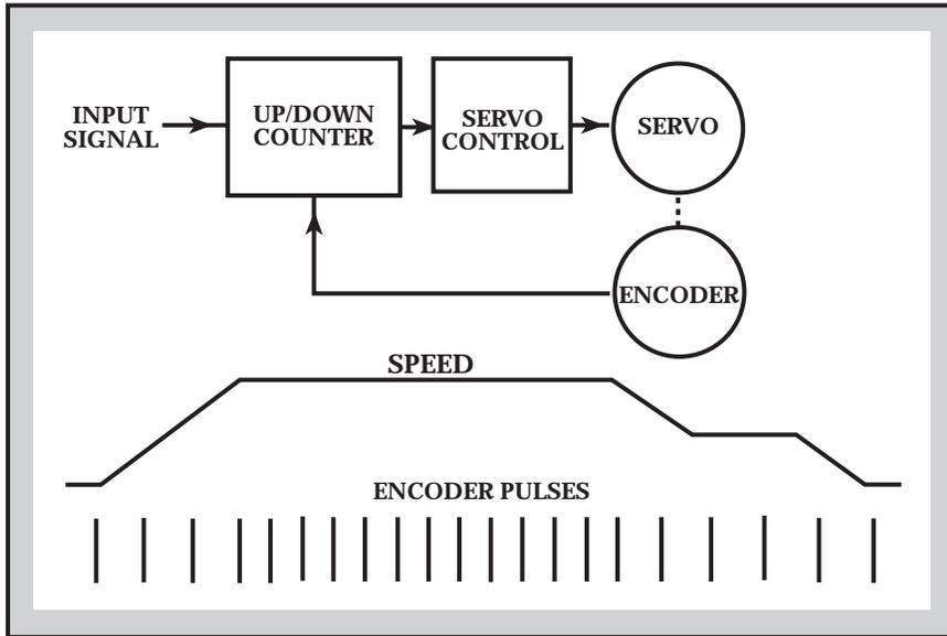
Fig. 24 - EXAMPLE USING ENCODER PULSES
