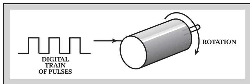
*Fig. 8 - STEPPER MOTOR*
