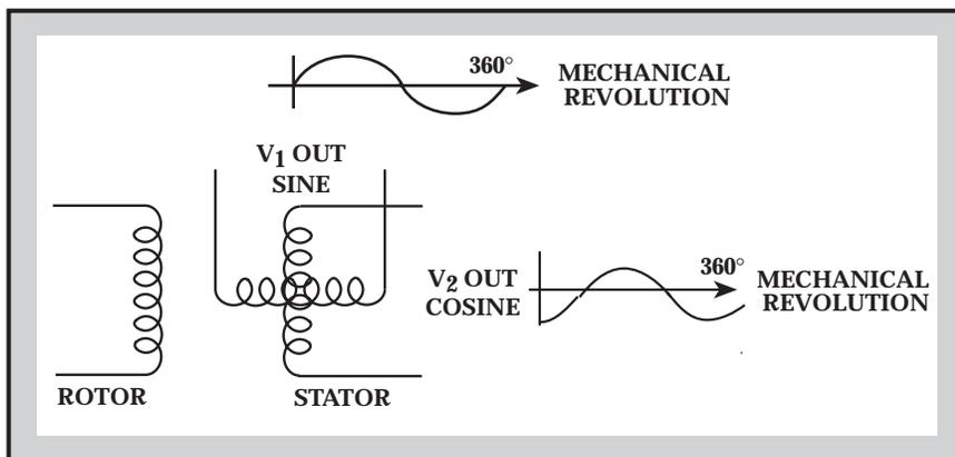
Fig. 26 - TYPICAL RESOLVER OUTPUT
