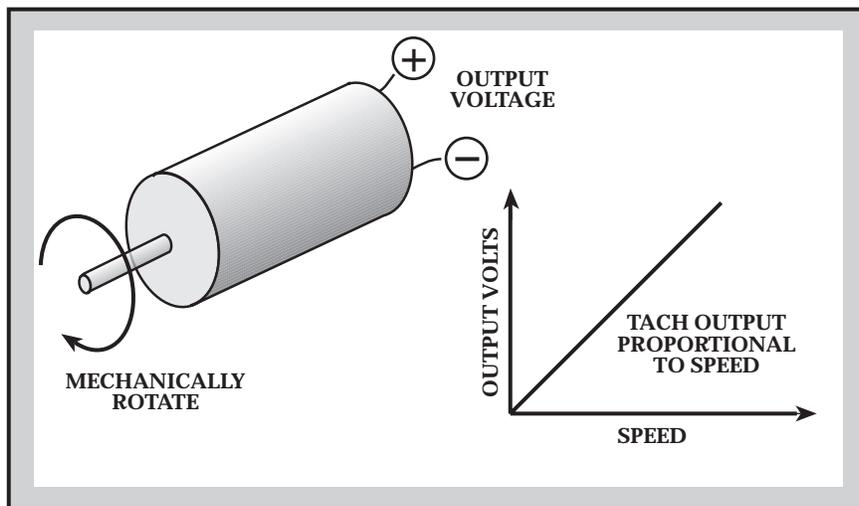
Fig. 19 - TACHOMETER
