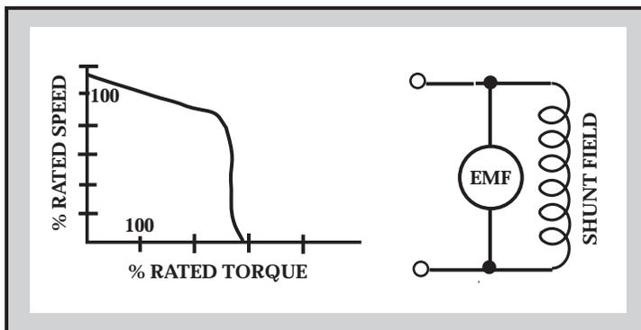
Fig. 5 - TYPICAL SPEED-TORQUE CURVE FOR SHUNT WOUND MOTORS
