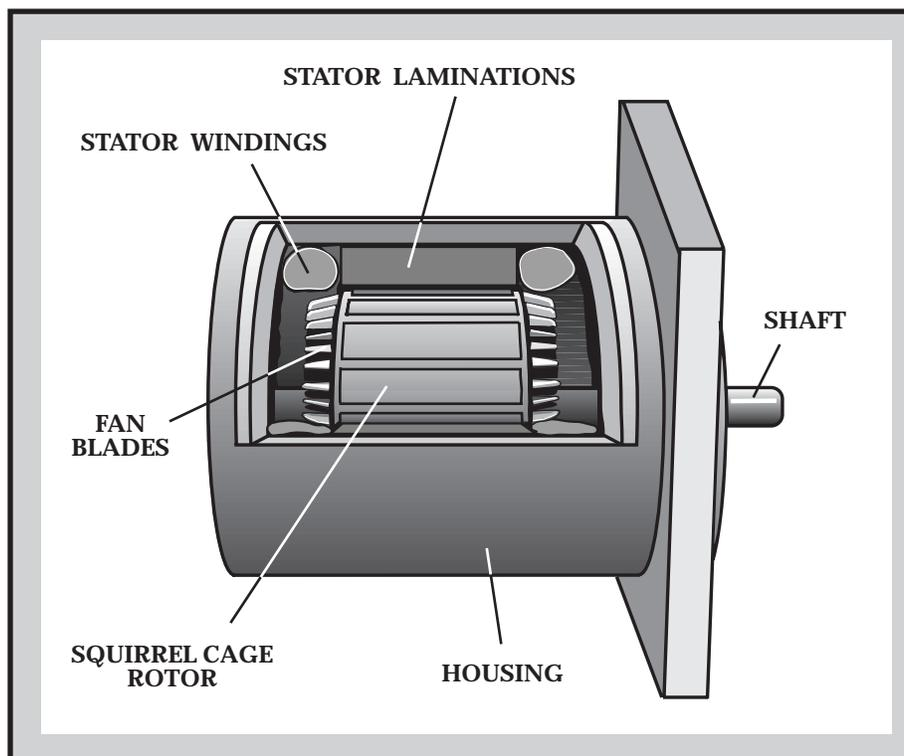
*Fig. 3 - CUTAWAY OF INDUCTION MOTOR*
