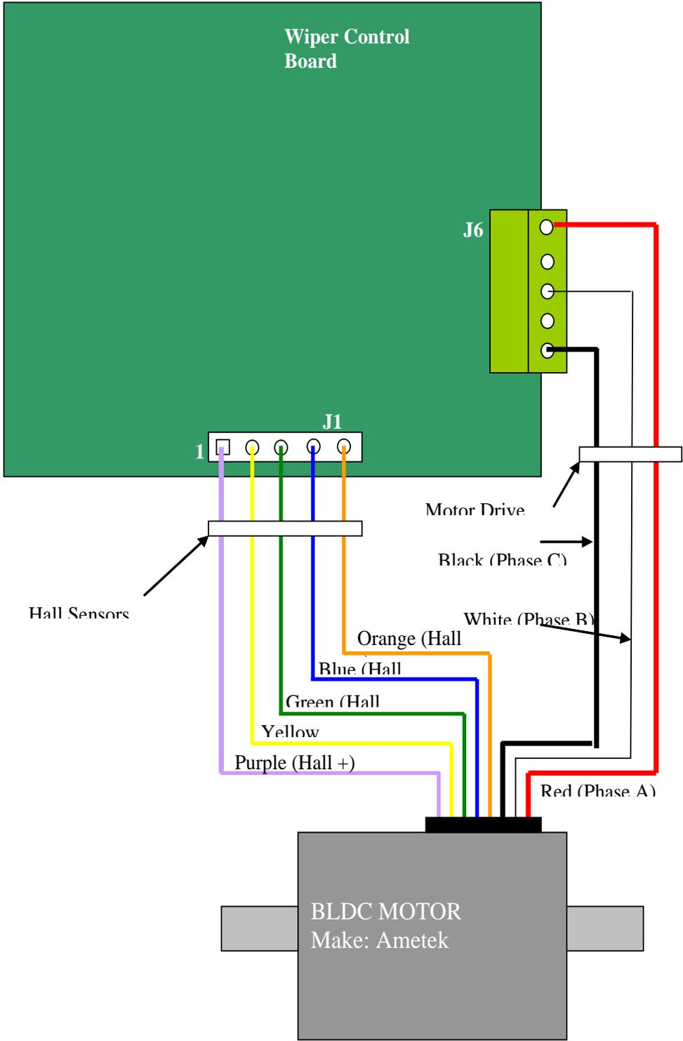
Figure 29. Ametek Motor Wiring Guide
