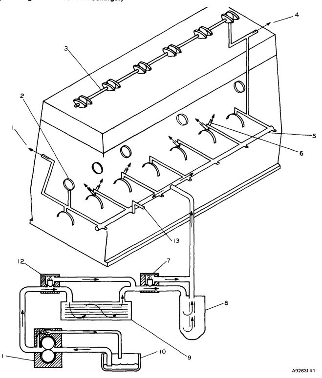
**LUBRICATION SYSTEM SCHEMATIC**
