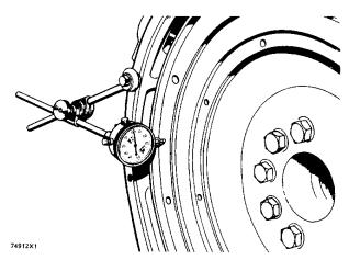
CHECKING FACE RUNOUT OF THE FLYWHEEL
