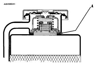
SCHEMATIC OF PRESSURE CAP
