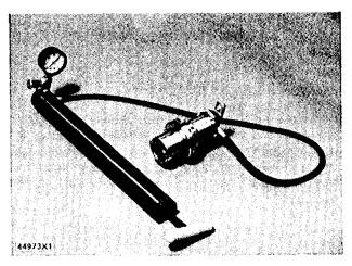
9S8140 COOLING SYSTEM PRESSURIZING PUMP GROUP
