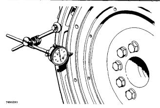
CHECKING FACE RUNOUT OF THE FLYWHEEL
