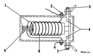
SCHEMATIC OF A SOLENOID
