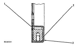
CROSS SECTION OF A TYPICAL VIBRATION DAMPER
