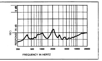
FIGURE 13 — Impedance EV DH1 Driver on EV HR9040 Horn
