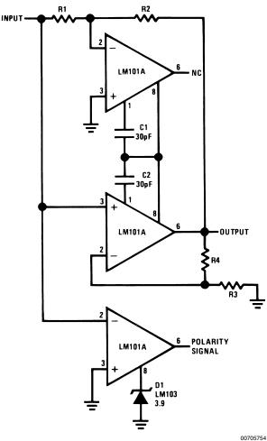
$$\begin{split} V_{OUT} &= - \left| V_{IN} \right| \times \frac{R2}{R1} \\ \frac{R2}{R1} &= \frac{R4 + R3}{R3} \end{split}$$
