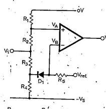
$\frac{R_1}{R_1 + R_2} = a$ ;  $\frac{R_3}{R_3 + R_4} = b$ ;  $R_5 \gg R_3 \parallel R_4$
