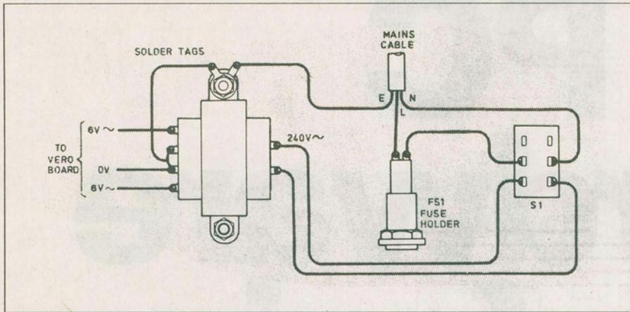
Fig. 5. Supply wiring
